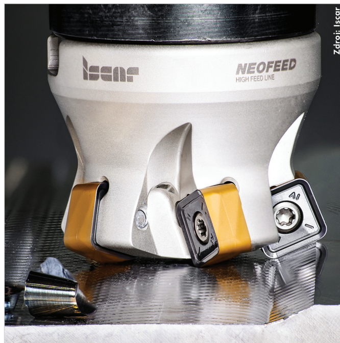
Řada nástrojů Neofeed využívá čtvercové oboustranné destičky s osmi řeznými hranami spolehlivě upnuté v rybinovém lůžku, které zajišťuje odolnost vůči zvýšenému zatížení při frézování s vysokými posuvy.
